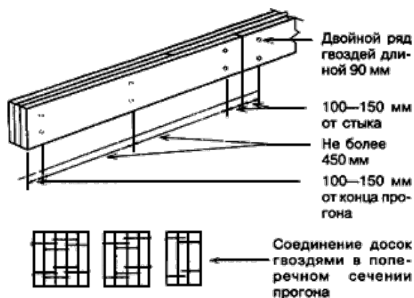
Рисунок 6-1 - Деревянные прогоны составного сечения
