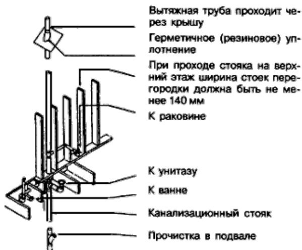
Рисунок 13-8 - Прокладка канализационных труб в каркасе дома
