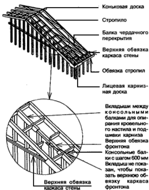
Рисунок 8-7 - Карниз над фронтоном с выносом более 300 мм
