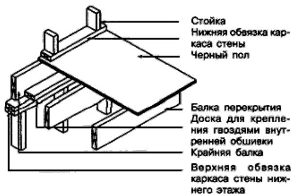
Рисунок 7-4 - Деталь установки доски для крепления внутренней обшивки
